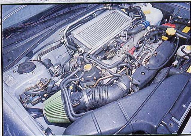
Le moteur est passé à 270 chevaux grâce à une gestion électronique modifiée, une admission directe, un peu de pression de sural<sup>1</sup> et la ligne complète d'échappement.
