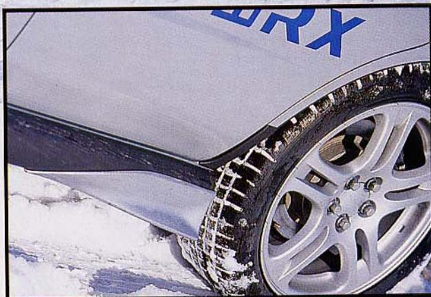
*On a chaussé des 17 pouces avec des pneus neige pour rouler à l'Alpe d'Huez, mais il est prévu une extension à 18 pouces pour les amateurs de pneus à profil bas. Les gros freins ne tolèrent pas de dimension inférieure à 17 pouces.*
